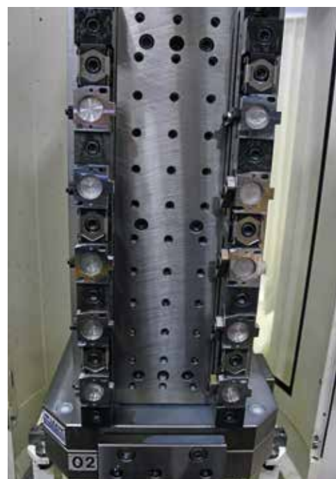
Uppspänt på kub, det handlar om 50 minuters bearbetning.
