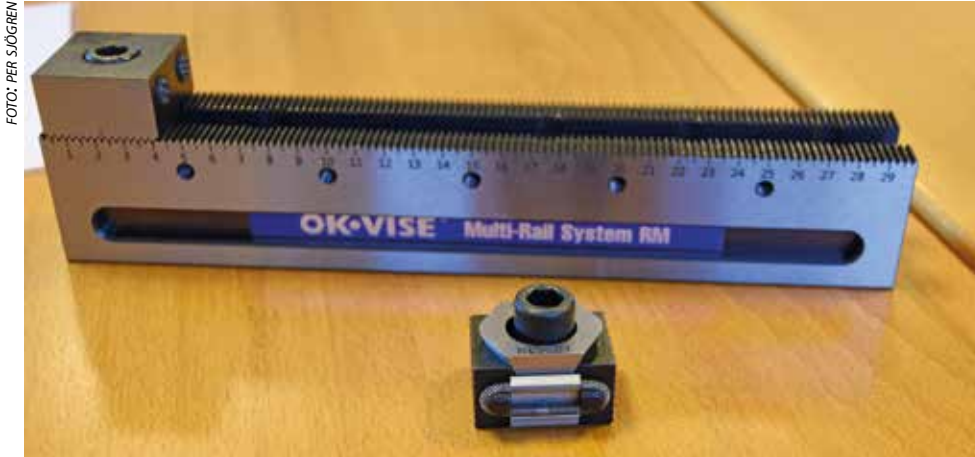
På bilden ses en spännare och en baslist från OK Vise.
