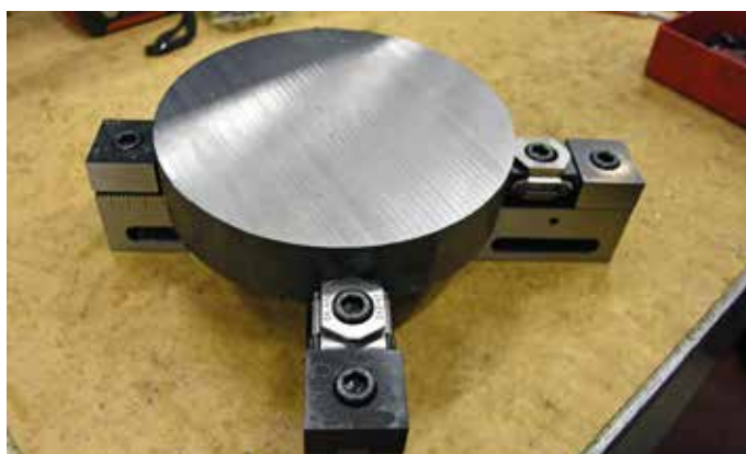
OK Vises system är mycket flexibelt. Ämnen kan spännas upp på flera olika sätt då en uppspänning kan anpassas efter hur ämnet ser ut. Vill man spänna upp ett runt ämne på en kub så ser det ut så här.
